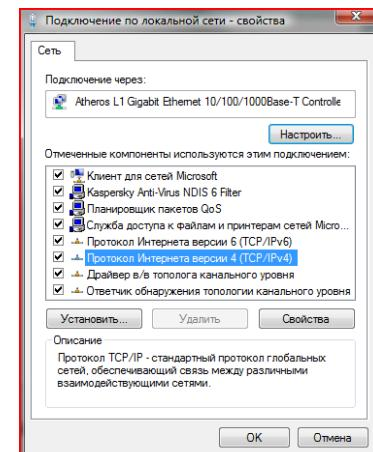
использоваться для соединения с IP-устройством.
